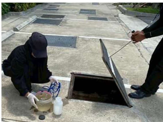
น้ำออกจากระบบบำบัดน้ำเสีย 80 ลบ.ม. อาคาร C2
